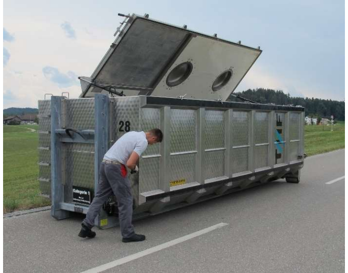
Durch eine Hydraulikpumpe auf der Hakenseite lässt sich der Muldendeckel leicht von Hand öffnen.
