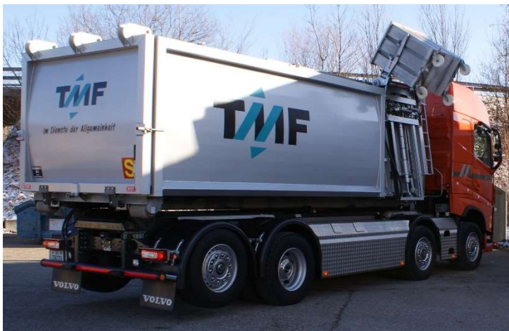
Mulde mit Seitenlift für das Beladen mit 800l-Containern.
