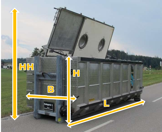
Grosser Muldendeckel für einfaches Beladen der Kadaver.
